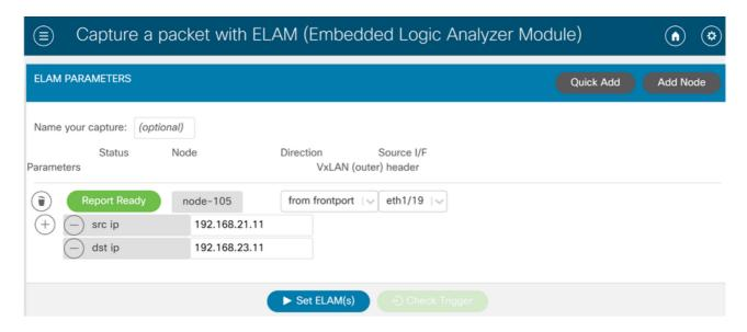
En général, l'utilisateur configure les détails de la source et de la destination pour le flux concerné. Dans cet exemple, src IP est utilisé pour capturer le trafic vers le point d'extrémité dans l'EPG de destination qui n'a pas de relation contractuelle avec l'EPG source.
