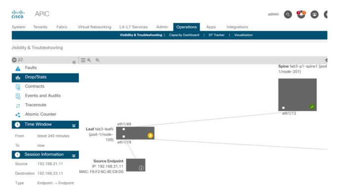
L'outil visualise automatiquement la topologie du scénario de dépannage. Dans ce cas, les deux points d'extrémité sont connectés au même commutateur leaf.
