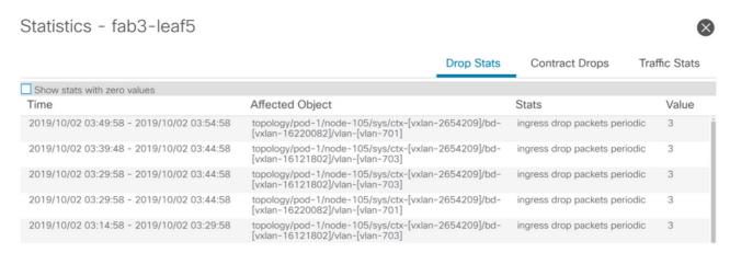
En effectuant une hiérarchisation vers le bas pour supprimer les détails à l'aide du bouton jaune « Packets drop » sur le schéma du commutateur, l'utilisateur peut afficher les détails du flux supprimé.
