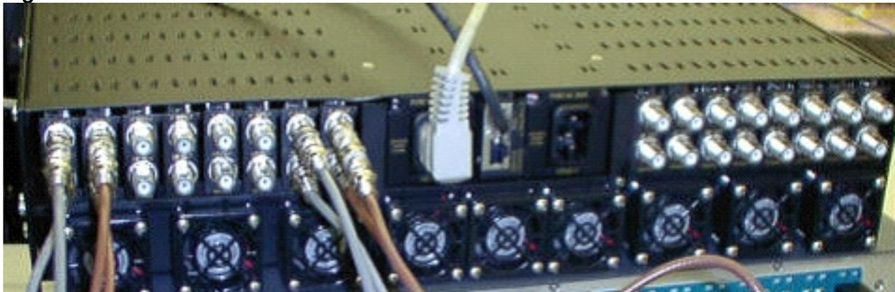
Les modules sont étiquetés de A à P et sont corrélés aux modules 1 à 16 lorsque vous configurez les configurations du 7200. Les modules de la Figure 1 sont affichés de droite à gauche, car la Figure 1 est la vue arrière.
