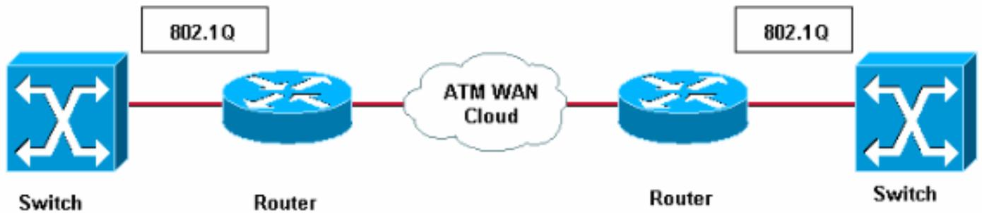
Cependant, il existe une autre façon de créer des VLAN de bout en bout. Configurez les deux routeurs avec le même ensemble de groupes de ponts et de sous-interfaces 802.1Q. En d'autres termes, les deux extrémités du routeur ont un mappage un-à-un entre un groupe de ponts et une sous-interface 802.1Q. Cela ne s'applique pas au Cisco 7600.
