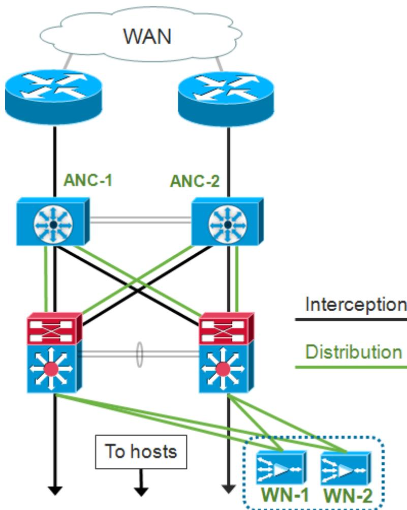
La configuration d'interface d'un déploiement en ligne attribue les rôles d'interception et de distribution à des interfaces distinctes sur le module d'interface du contrôleur Cisco AppNav. Une interface de groupe de ponts est requise pour l'interception et se compose de deux interfaces physiques ou de canal de port ou une de chacune. L'interface de groupe de ponts ne manque pas
