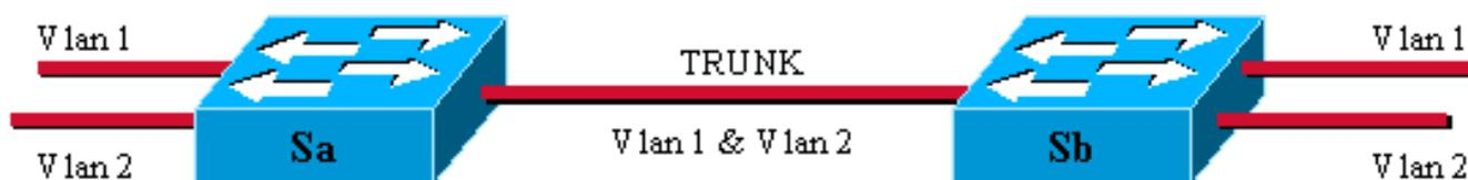
Dans ce diagramme, le seul lien physique entre les deux Commutateurs peut porter le trafic pour Qu'est ce que VLAN. Afin de réaliser ceci, chaque trame envoyée sur le lien est étiquetée par SA de sorte que le Sb sache à quel VLAN il appartient. le 802.1Q utilise un mécanisme de balisage interne. Interne signifie qu'une balise est insérée dans la trame, comme affiché ci-dessous.
