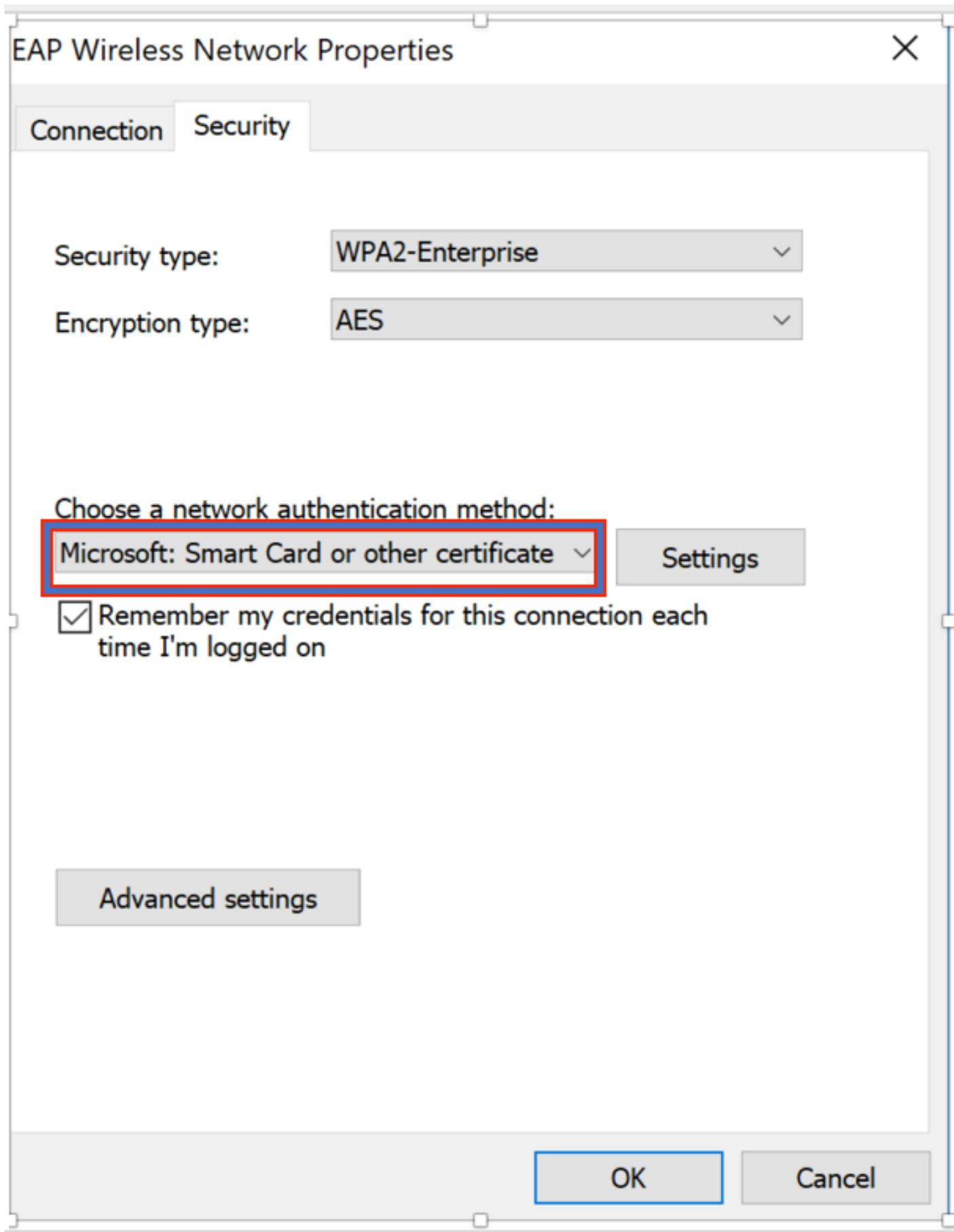
Paso 3. Haga clic en **configuración** y seleccione el certificado raíz emitido desde el servidor de la CA como se muestra en la imagen.
