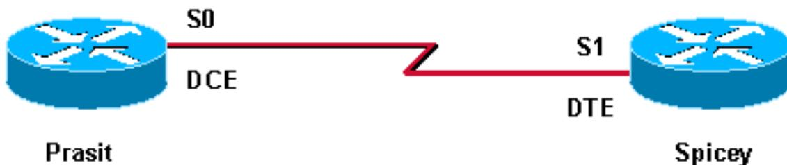
La encapsulación serial predeterminada es Cisco High-Level Data Link Control (HDLC). Debe configurar explícitamente el método de encapsulación X.25 usando el comando **encapsulation x25**. La opción **dce** especifica la operación como un dispositivo DCE X.25 lógico.
