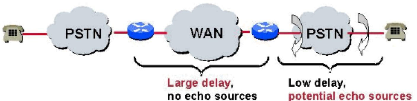
La demora introducida por la voz del paquete es inevitable. Por lo tanto, los gateways de voz deben evitar el eco. Este diagrama ilustra cómo el gateway puede reducir el eco antes de que pueda ingresar a la red de voz de paquetes con el uso de un cancelador de eco.
