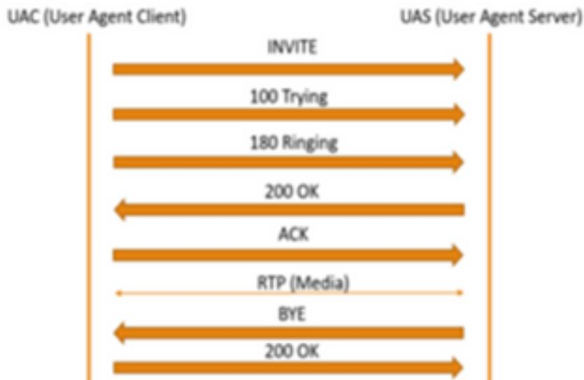
Cuando una ASA enciende la inspección de SIP, el ASA inserta su dirección IP en el parámetro c de la SDP (información de conexión para devolver llamadas a) o en el encabezado SIP. A continuación se muestra un ejemplo de cómo se ve una llamada fallida cuando se activa la inspección SIP:
