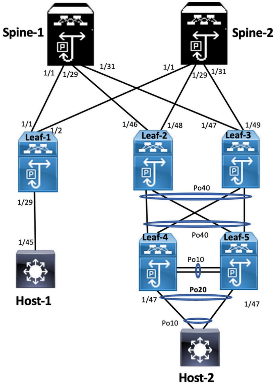
En vPC de doble cara, ambos switches Nexus 9000 ejecutan vPC. Cada par vPC de switches Nexus 9000 se conecta al par vPC de agregación con un vPC único.
