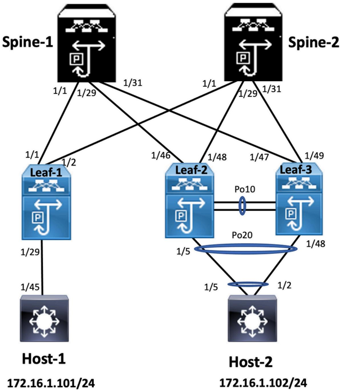
En el diagrama, el host se conecta a un par de switches Nexus 9000 que incluyen una ID de dominio de vPC, pero los switches configurados por el host no ejecutan vPC por sí mismos. El switch/host de acceso registra el enlace ascendente como un canal de puerto simple sin conocimientos de vPC.
