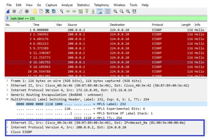
Wireshark muestra correctamente el tráfico Vlan 200 como paquetes EIGRP
