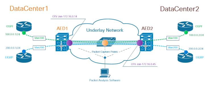
**Nota**: la solución Cisco OTV utiliza el concepto de función de dispositivo de extremo autorizado (AED), asignado a un dispositivo de red que encapsula y desencapsula el tráfico de OTV en un sitio determinado.
