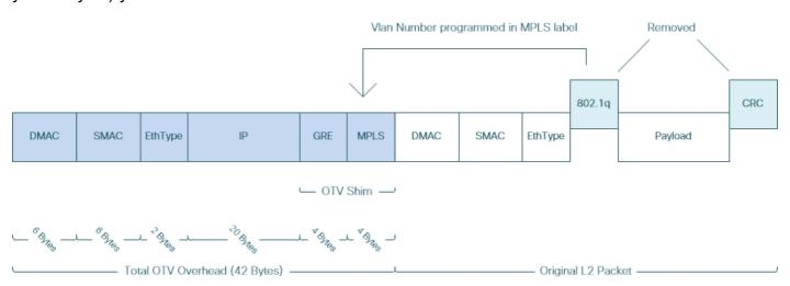
En las soluciones L2VPN MPLS, los dispositivos de la red subyacente no tienen suficiente información para decodificar correctamente la carga útil del paquete MPLS. Normalmente, esto no es un problema, ya que el reenvío de paquetes en una red de núcleo MPLS se realiza en base a las etiquetas, por lo tanto, no se requiere un análisis en profundidad del contenido de los paquetes MPLS en la red subyacente.
