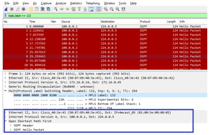
Wireshark muestra correctamente el contenido de los paquetes encapsulados por OTV
