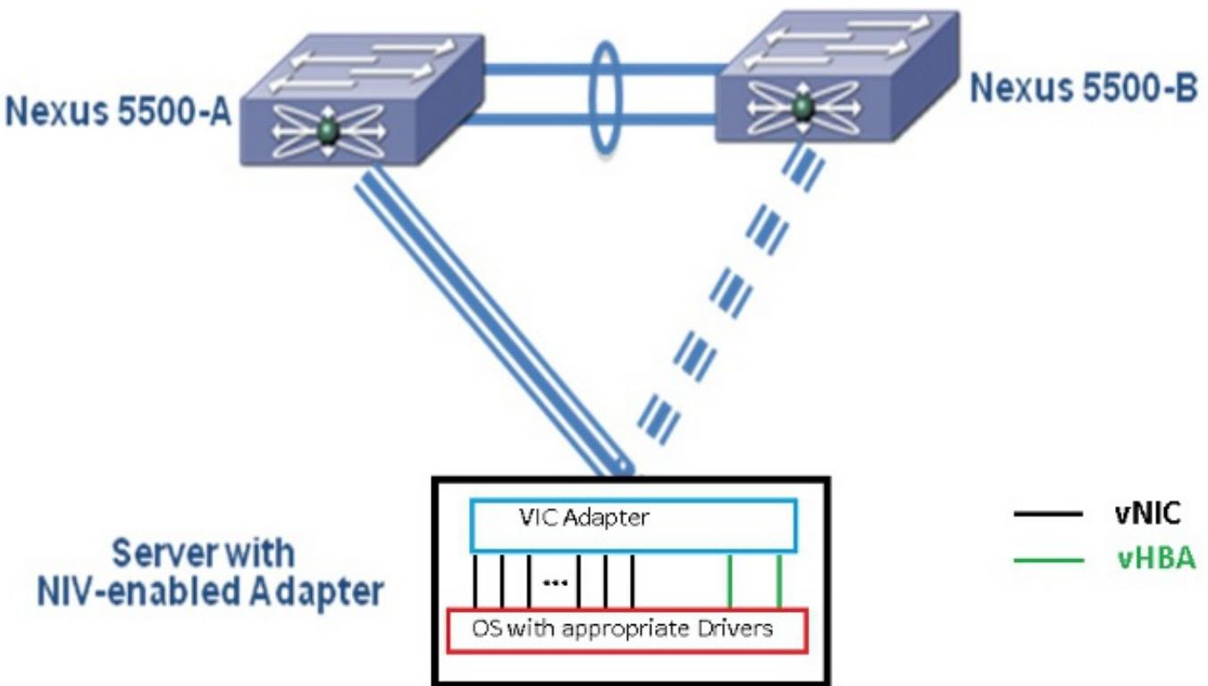
Cada vNIC tendrá una interfaz Ethernet virtual correspondiente en el Nexus 5000. Asimismo, cada vHBA tendrá una interfaz de canal de fibra virtual (VFC) correspondiente en el Nexus 5000.
