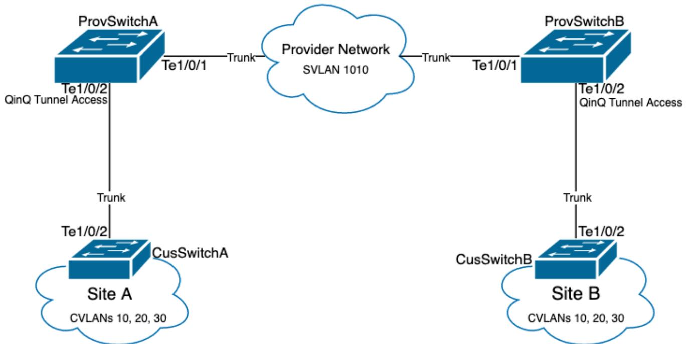
Configuración en ProvSwitchA (dispositivo PE de túnel QinQ):
