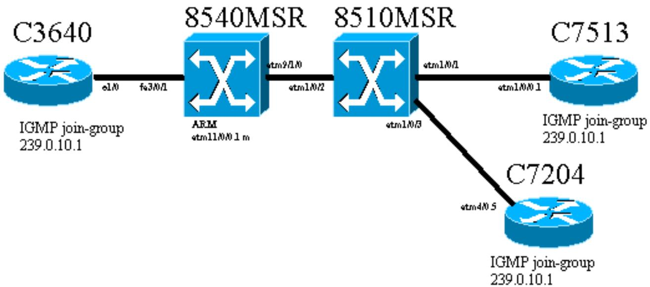
El router Cisco 3640, conocido como C3640, está conectado al Cisco Catalyst 8540 MSR (conocido como 8540MSR) a través del puerto Fast Ethernet 3/0/1. El 8540MSR tiene un ARM en la ranura 11. El C8540MSR está conectado físicamente al 8510MSR mediante la **interfaz atm 9/1/0**. El switch ATM 8510MSR se conecta con el 8540MSR en la interfaz ATM 1/0/2.
