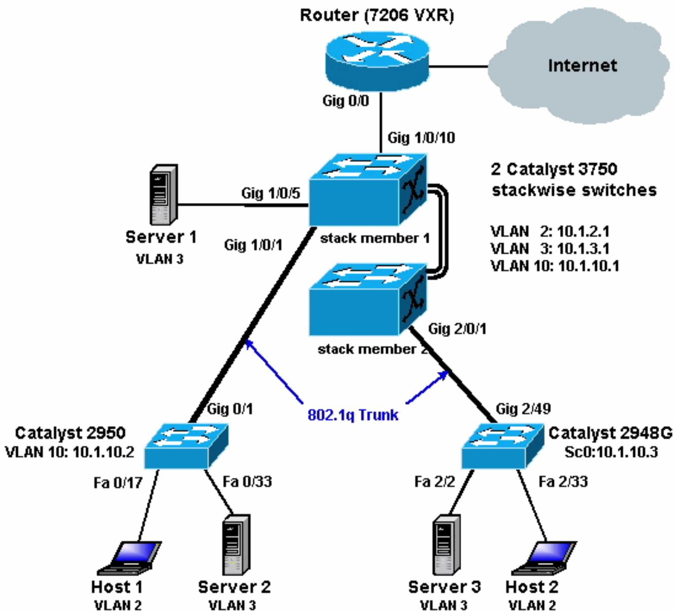
El diagrama anterior muestra una pequeña red de muestra con la pila de Catalyst 3750 que proporciona ruteo entre VLAN entre los diversos segmentos.
