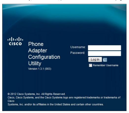
La dirección IP predeterminada del adaptador telefónico es 192.168.15.1. Si no aparece ninguna página web, intente restablecer la dirección IP. Para restablecer la dirección IP, mantenga presionado el botón reset durante 30 segundos. Esto restablece la dirección IP predeterminada así como todos los demás parámetros a los valores predeterminados de fábrica. Alternativamente, puede configurar manualmente la dirección IP del equipo host para que esté en
