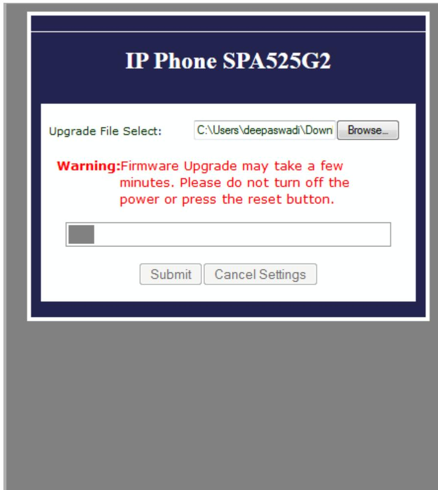
Paso 9. Haga clic en Submit (Enviar). Una vez que la actualización del firmware se realiza correctamente, el sistema comienza a reiniciarse. Después de que se reinicie, una ventana muestra "Actualización correcta del firmware".
