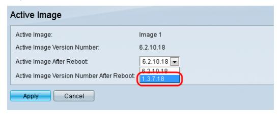
Paso 3. Haga clic en **Apply** para elegir el firmware que se utilizará al reiniciar el switch.
