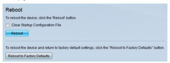
Paso 2. (Opcional) Marque la casilla de verificación **Clear Startup Configuration File** para eliminar la configuración de inicio una vez que se reinicia el switch. Con esta opción habilitada, el switch realiza esencialmente un restablecimiento predeterminado de fábrica ya que tanto la configuración en ejecución como la de inicio se eliminarán al reiniciar.
