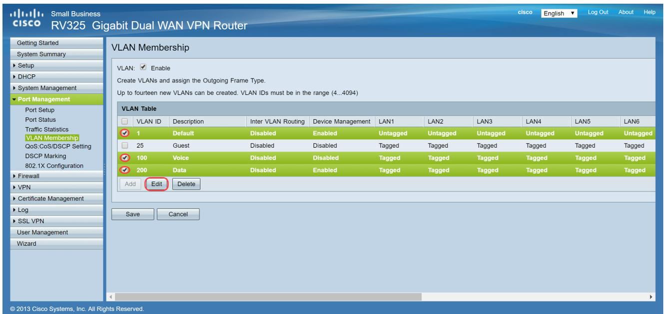
Paso 6. (Opcional) En la lista desplegable Inter VLAN Routing, elija Enabled o Disabled para rutear paquetes de una VLAN a otra VLAN. Esta opción es útil porque los administradores de red internos podrán acceder de forma remota a sus dispositivos para ayudar a solucionar sus problemas. Esto reducirá el tiempo de tener que cambiar constantemente las VLAN para acceder a los dispositivos.
