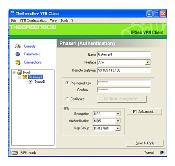
Paso 25. En el campo Remote Gateway (Gateway remoto), introduzca la dirección IP de WAN del router remoto.
