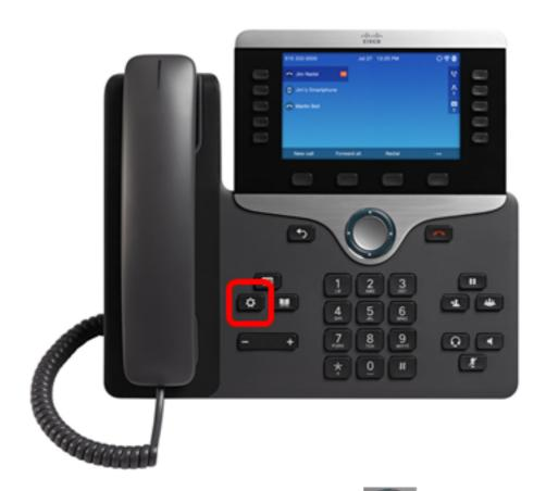
Paso 2. Con el botón del grupo de navegación , navegue hasta **Estado** y, a continuación, presione la tecla programada **Seleccionar**.
