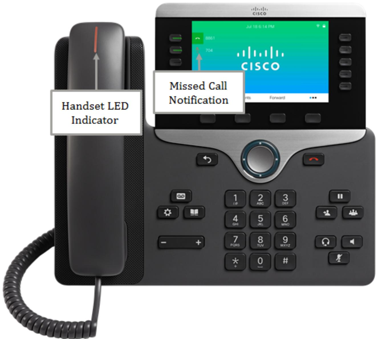
Ahora debería haber configurado correctamente el indicador de llamadas perdidas en el teléfono multiplataforma Cisco IP Phone serie 8800 a través de la utilidad basada en Web.
