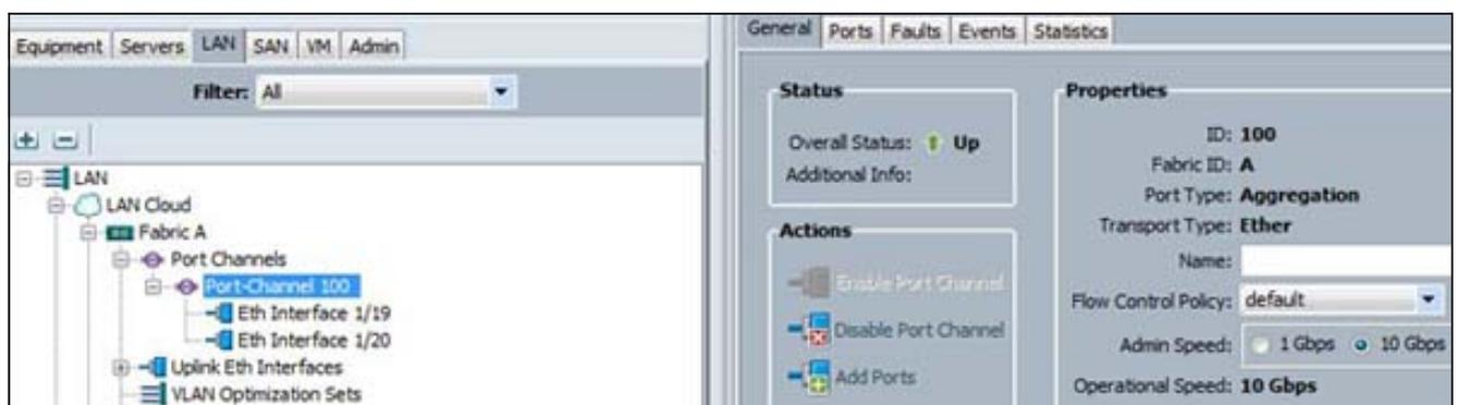
Si el switch ascendente se configura correctamente, el estado general pasa a un estado Up.
