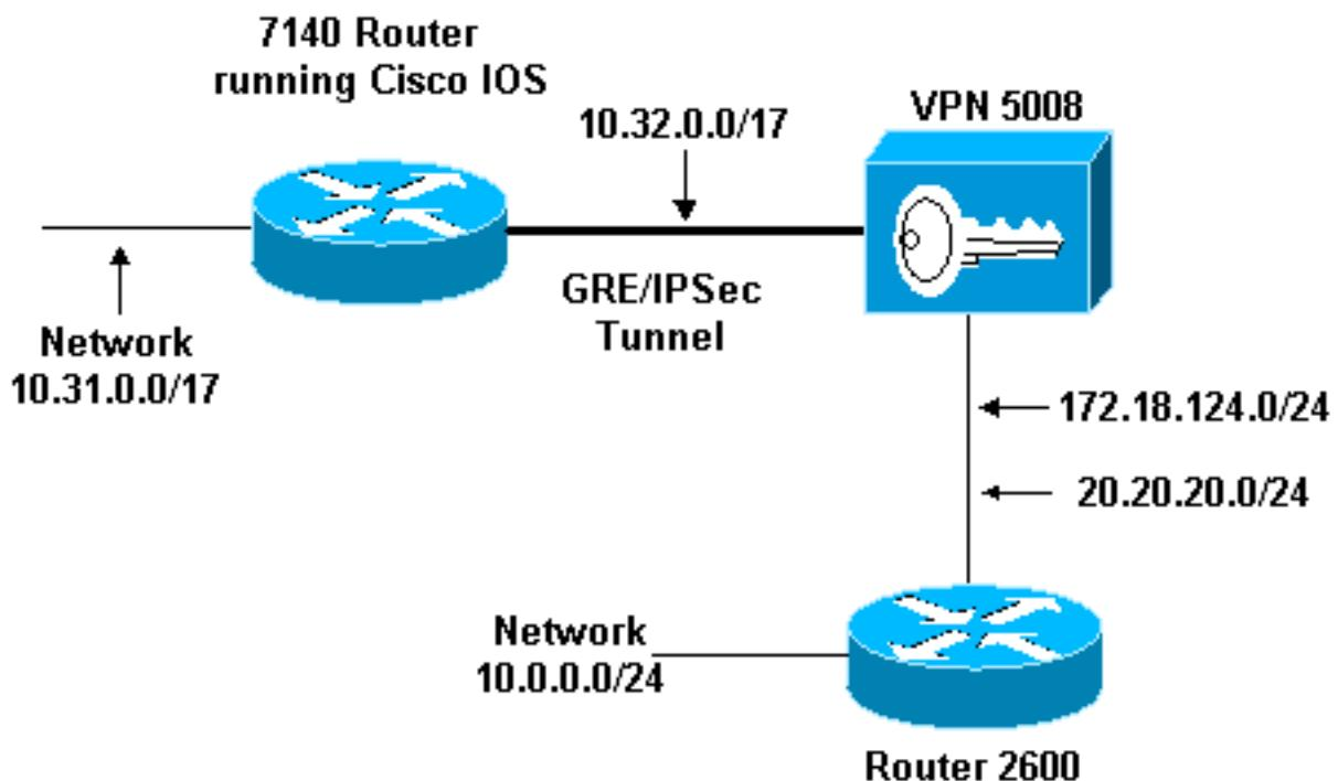
El GRE sobre IPSec se configura entre el router Cisco IOS (7140) y el concentrador Cisco VPN 5008. Detrás de estos dispositivos, se anuncian varias redes a través de RIP, que se ejecuta dentro del túnel GRE entre 7140 y VPN 5008.
