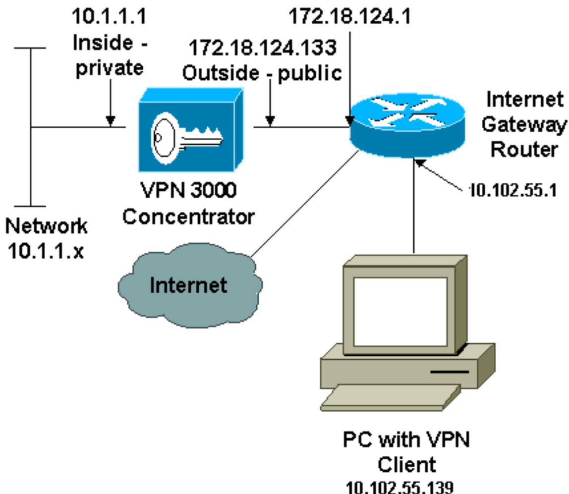
**Nota:** Los esquemas de direccionamiento IP utilizados en esta configuración no son legalmente enrutables en Internet. Son direcciones RFC 1918 que se utilizaron en un entorno de laboratorio.
