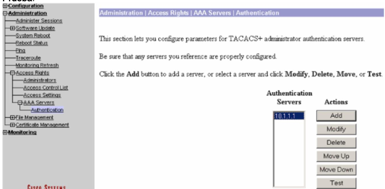
**Nota:** Cuando el servidor TACACS+ está configurado en la ficha Administration (Administración), no hay forma de configurar el usuario para autenticarse en la base de datos local VPN 3000. Sólo puede realizar una reserva utilizando otra base de datos externa o servidor TACACS. Introduzca el nombre de usuario y la contraseña de TACACS+ y haga clic en
