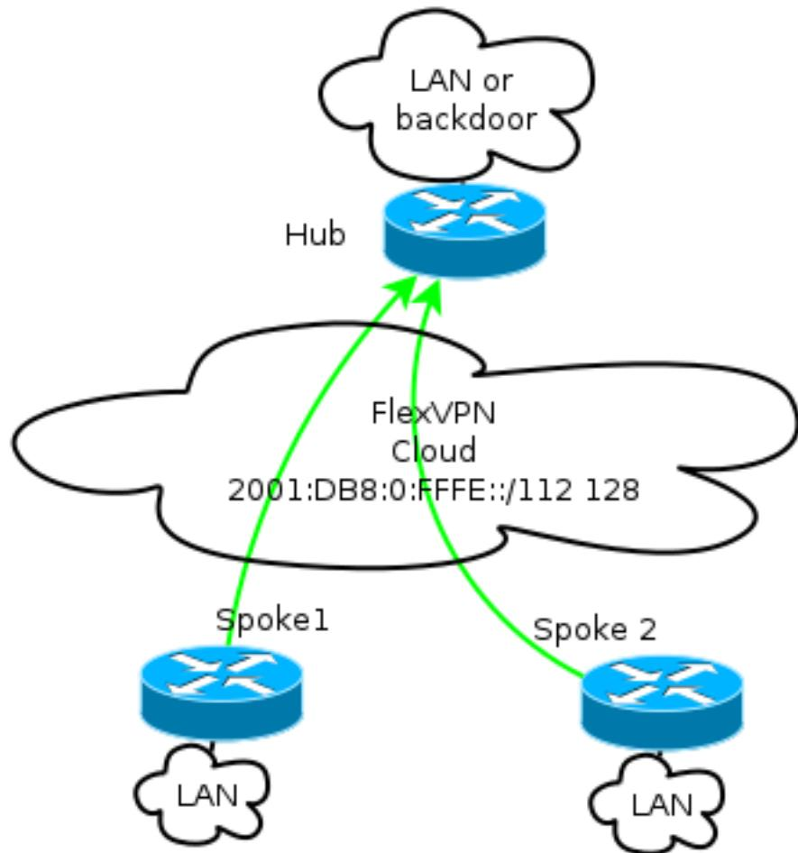
Cada radio se asigna desde un conjunto de direcciones de /112, pero recibe una dirección /128. Por lo tanto, la notación '/112 128' se utiliza en la configuración del conjunto IPv6 del hub.
