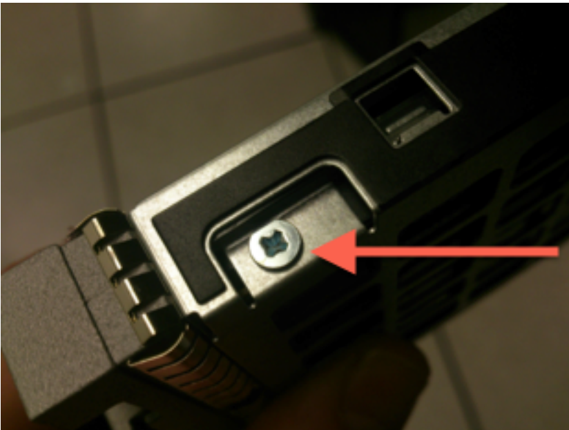
Figura: Los cuatro tornillos de cabeza Phillips fijan la unidad en el led: dos en cada lado.
