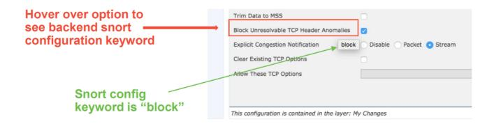
La opción **Block Unresolable TCP Header Anomalies** en la ficha NAP se traduce a la palabra clave **block** en el motor. Con esa información en mente, la configuración del motor se puede verificar desde el shell de expertos.
