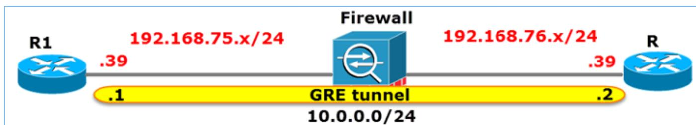
Cuando hace ping de R1 a R2 con el uso de un túnel GRE, el tráfico pasa a través del firewall, como se muestra en la imagen.
