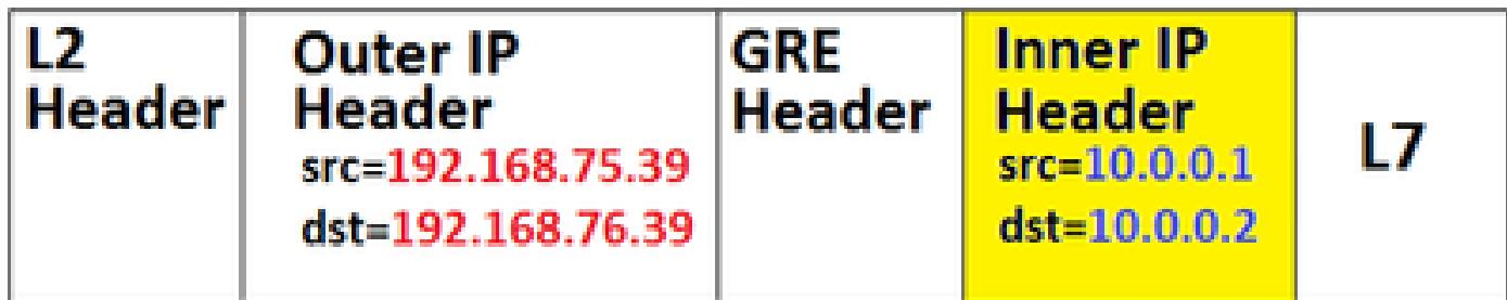
Con la política de filtro previo, un dispositivo FTD puede hacer coincidir el tráfico basado en encabezados internos y externos.
