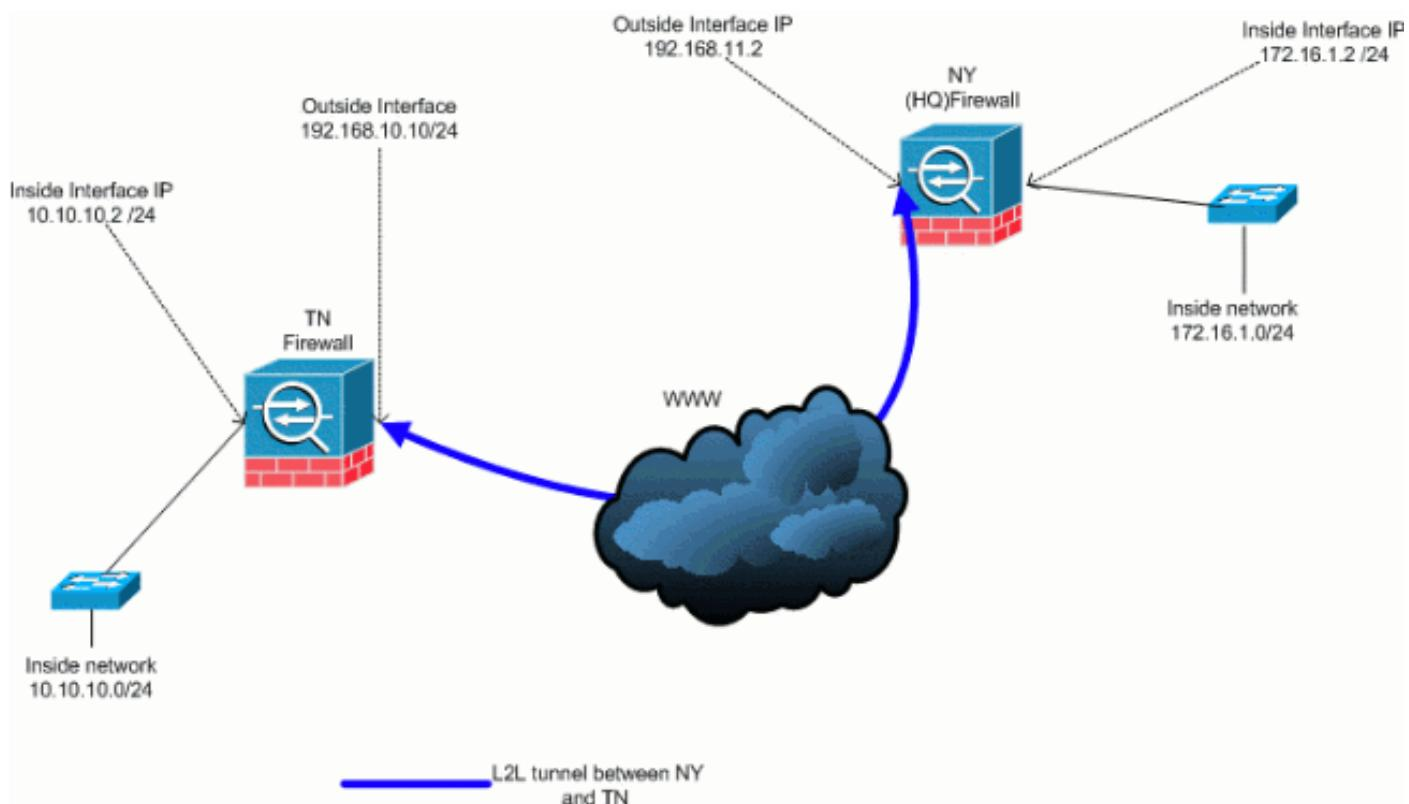
Este resultado es la configuración actual en ejecución del dispositivo de seguridad NY (HUB). En esta configuración, hay un túnel L2L IPSec configurado entre NY(HQ) y TN.
