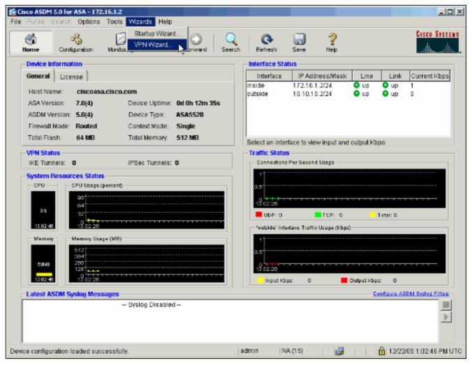
2. Seleccione el tipo de túnel **Remote Access VPN** y asegúrese de que la interfaz del Túnel VPN esté configurada según lo deseado.
