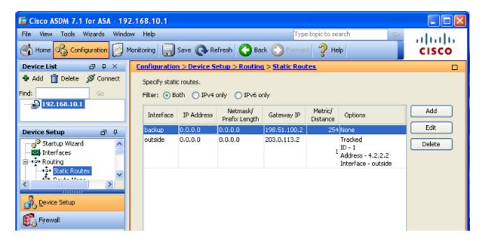
14. Seleccione la configuración de ruteo y luego haga clic en **Apply** para actualizar la configuración de ASA.
