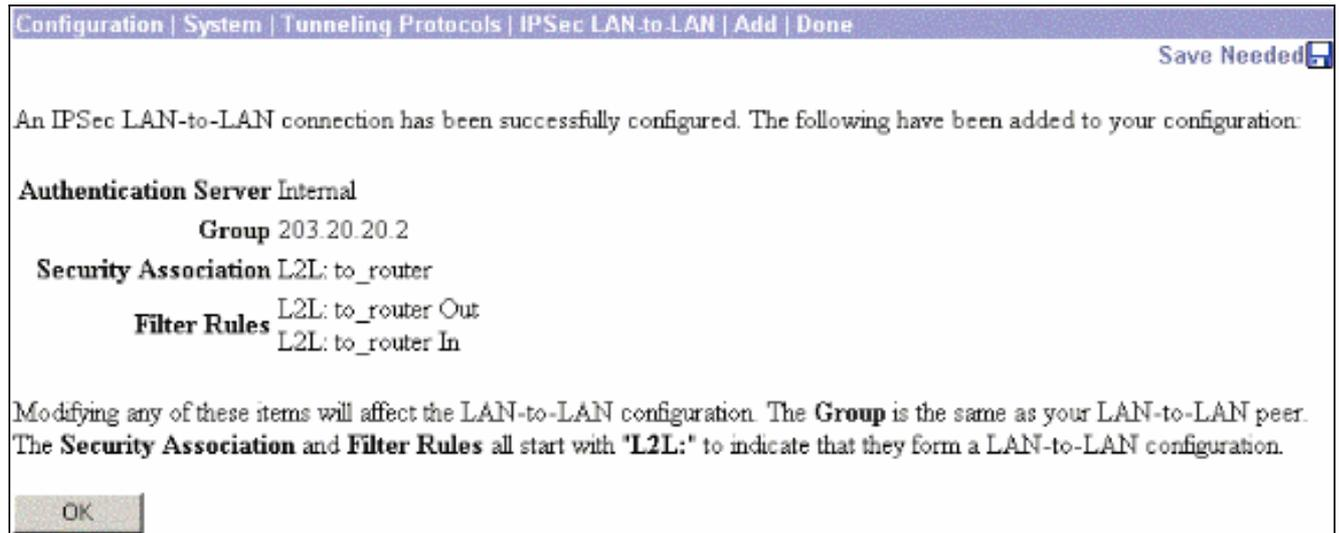
Los parámetros IPsec de LAN a LAN creados anteriormente se pueden ver o modificar en Configuración > Sistema > Tunelización de los Protocolos > IPsec LAN a LAN.
