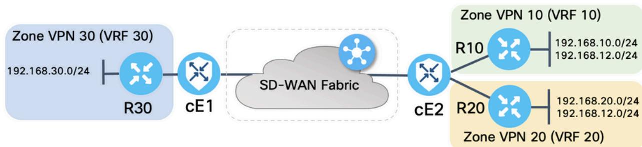
Ambos routers SD-WAN se configuraron con parámetros básicos para establecer conexiones de control con controladores SD-WAN y conexiones de plano de datos entre ellos. Los detalles de esta configuración están fuera de alcance a los efectos de este documento. La tabla aquí resume las asignaciones de VPN, ID de sitio y Zonas.
