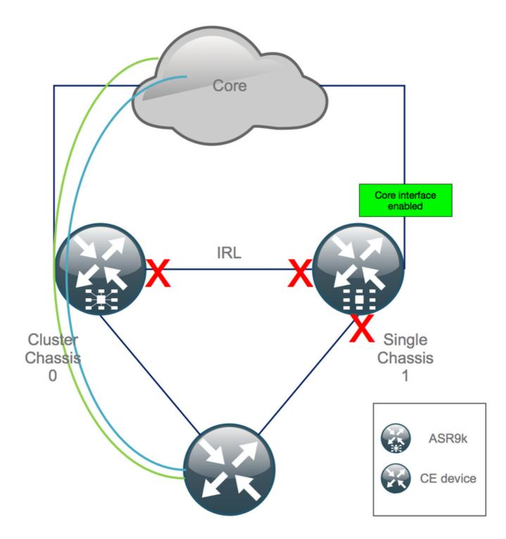
Paso 10. Conmutación por error: inicie sesión en el RSP activo del chasis 0 y coloque todas las interfaces en estado de desactivación por error
