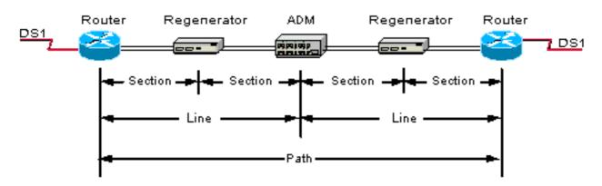
Cuando se conectan dos interfaces POS de router de punto a punto, en un enlace de multiplexación por división de longitud de onda densa (DWDM) sin equipo SONET intermedio o jerarquía digital síncrona (SDH), los tres mecanismos BIP supervisan el mismo segmento y normalmente detectan los mismos errores. Sin embargo, en esta configuración, B2 debe proporcionar el recuento de errores de bit más preciso.
