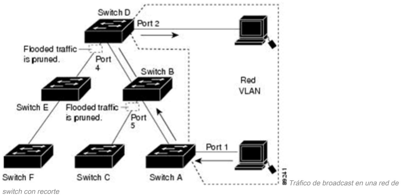
Esta figura muestra la misma red de switch con los recortes VTP habilitados. El tráfico de broadcast del Switch A no se reenvía a los switches C, E, y F porque el tráfico para la VLAN roja se ha recortado en los links mostrados (el Puerto 5 en el Switch B y el Puerto 4 en el Switch D).
