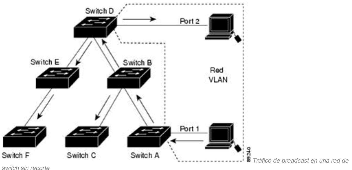
Esta figura muestra una red de switch sin los recortes VTP habilitados. El puerto 1 en el Switch A y el puerto 2 en el Switch D se asignan a la VLAN Roja. Si se envía un broadcast del host conectado al Switch A, el Switch A inunda el broadcast y cada switch en la red lo recibe, aunque los Switches C, E, y F no tienen puertos en la VLAN Roja.
