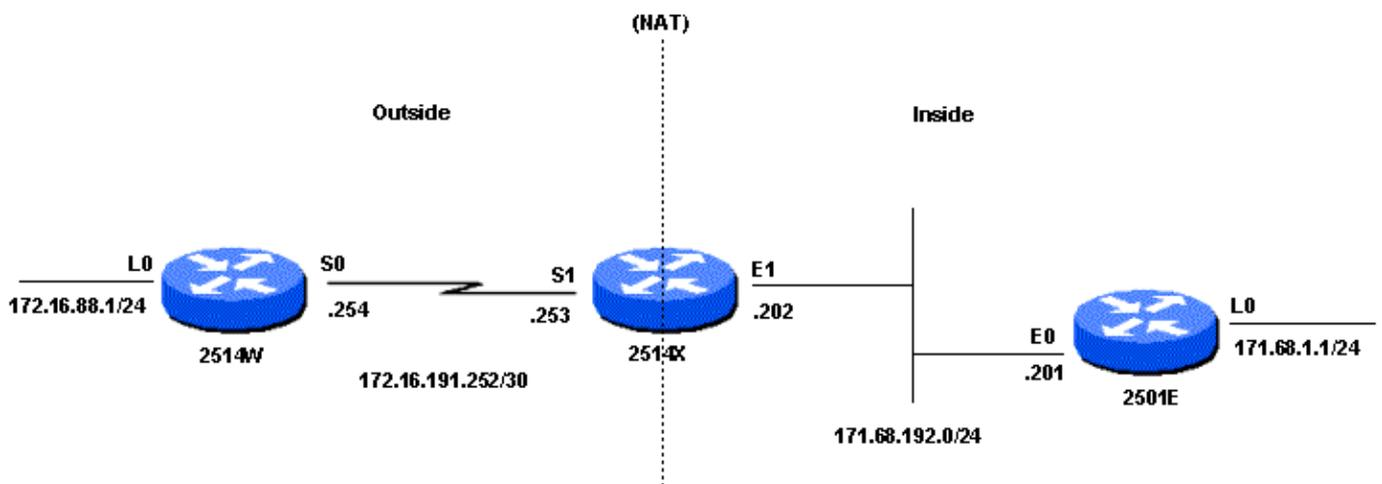
Cuando el ping es originado de la interfaz Loopback0 del Router 2514W (172.16.88.1) a la interfaz Loopback0 del Router 2501E (171.68.1.1), sucede lo siguiente:
