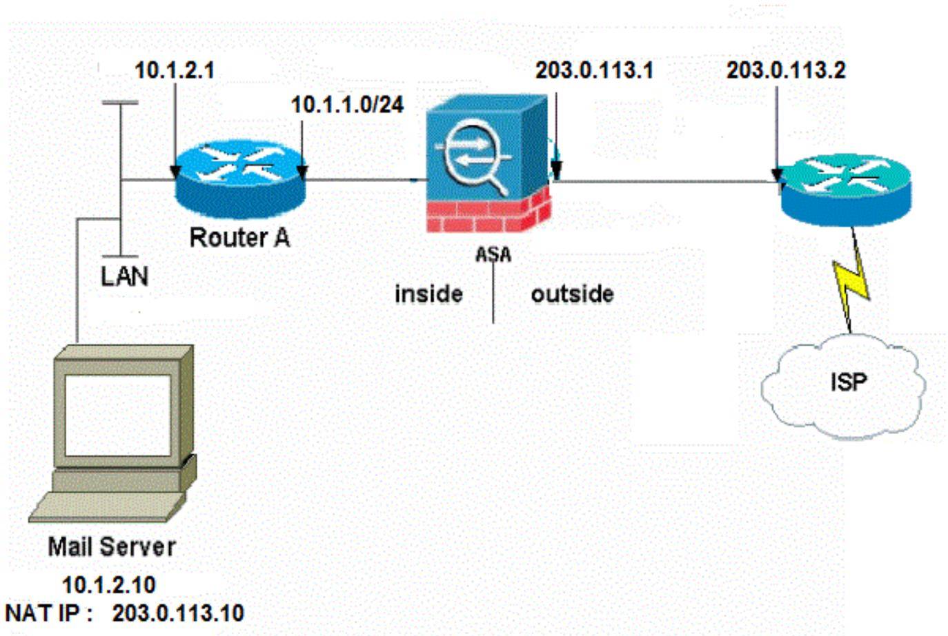
La configuración de red que se utiliza en este ejemplo tiene el ASA con una red interna en 10.1.1.0/24 y una red externa en 203.0.113.0/24. El servidor de correo con la dirección IP 10.1.2.10 se encuentra en la red interna.
