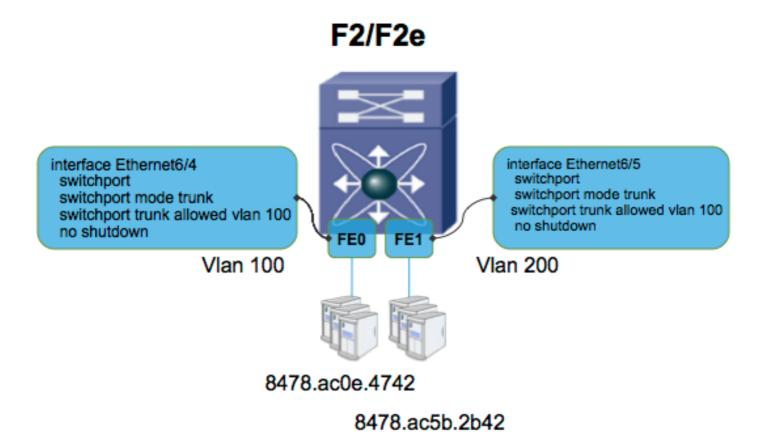
Después de eliminar las vlan, tiene una entrada menos por FE (SoC). El recorte de la vlan impidió una sincronización entre el FE para la dirección MAC.
