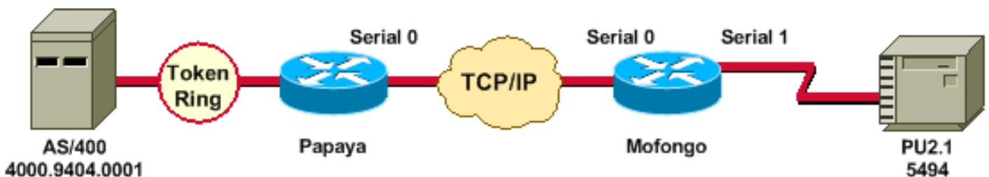
Después de que se activa la interfaz, el router inicia el proceso: determina la ubicación del controlador remoto.
