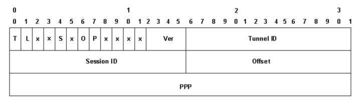
Si habilita la secuenciación de datos (está desactivada de forma predeterminada en los dispositivos Cisco), debe agregar 4 bytes adicionales para los campos Ns y Nr. Agregue los encabezados IP, UDP y L2TP para ver que L2TP sobre UDP agrega 40 bytes de encapsulación de protocolo al paquete.
