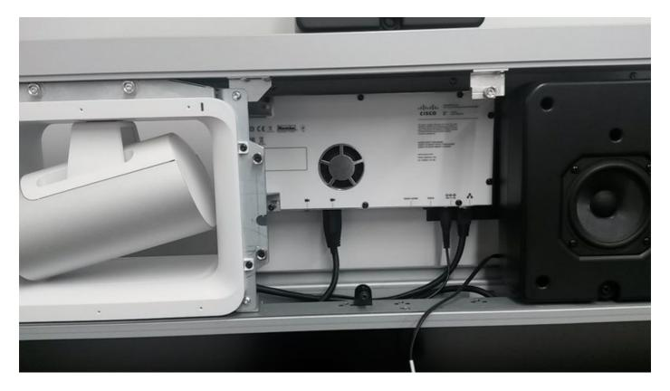
Paso 4. Al fondo del panel de control, al lado del tornillo, usted puede ver un agujerito. Presione el agujerito con una pluma por cerca de 15 segundos hasta que el diodo emisor de luz (LED) de la cámara centelle el rojo tal y como se muestra en de la imagen.
