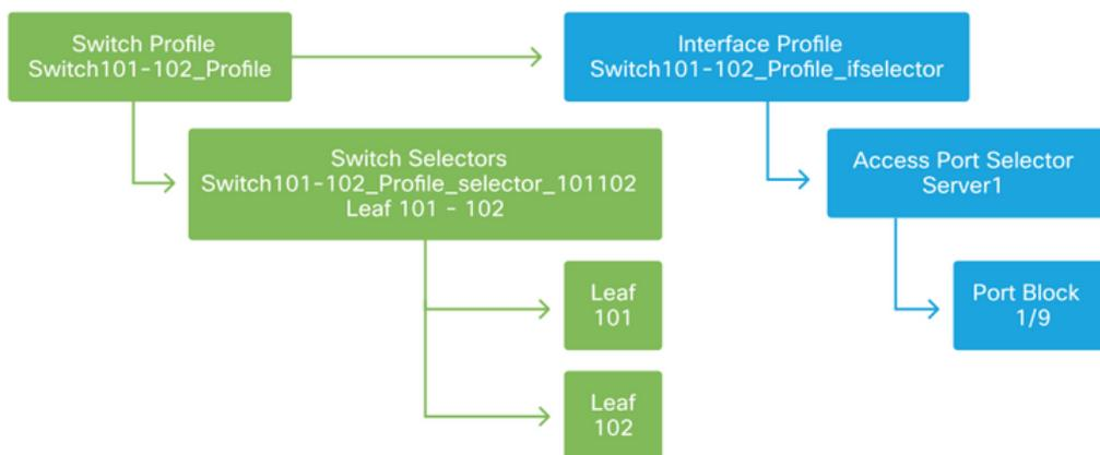
Observe que como un 'Perfil de interfaz' con Eth 1/9 está conectado a un 'Perfil de switch' que incluye el switch de hoja 101 y 102, el aprovisionamiento de Eth1/9 en ambos nodos comienza simultáneamente.
