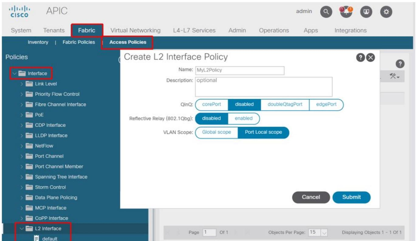
Antes de implementar la configuración de alcance de VLAN 'Port Local', consulte la "Guía de configuración de redes de capa 2 de Cisco APIC" en Cisco.com para asegurarse de que sus limitaciones y restricciones de diseño son aceptables para los diseños y casos prácticos deseados.
