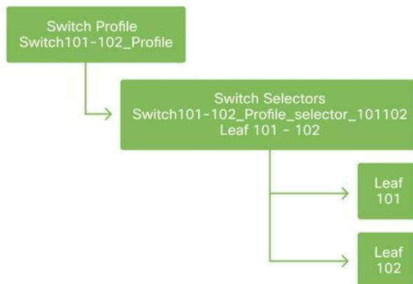
La recomendación general es configurar 1 perfil de switch por switch de hoja individual y 1 perfil de switch por par de dominios VPC, usando un esquema de nomenclatura que indique los nodos que forman parte del perfil.
