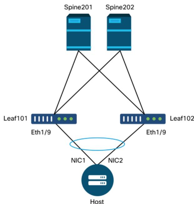
Un servidor web está conectado a un fabric ACI. El servidor web tiene 2 tarjetas de interfaz de red (NIC) configuradas en un canal de puerto LACP. El servidor web está conectado al puerto 1/9 de los switches de hoja 101 y 102. El servidor web depende de VLAN-1501 y debe residir en el EPG 'EPG-Web'.
