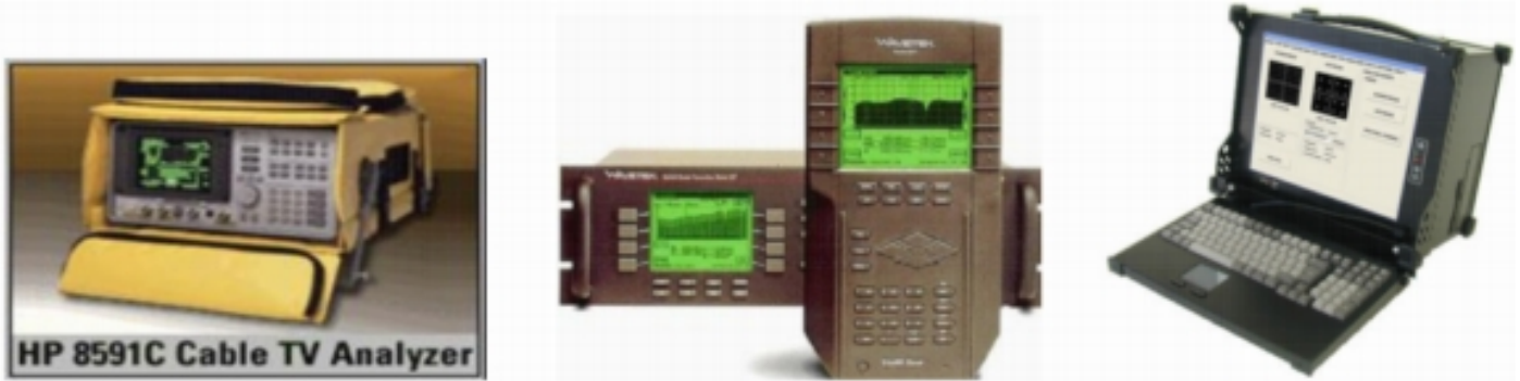
Figura 1: Equipo de prueba de cables
