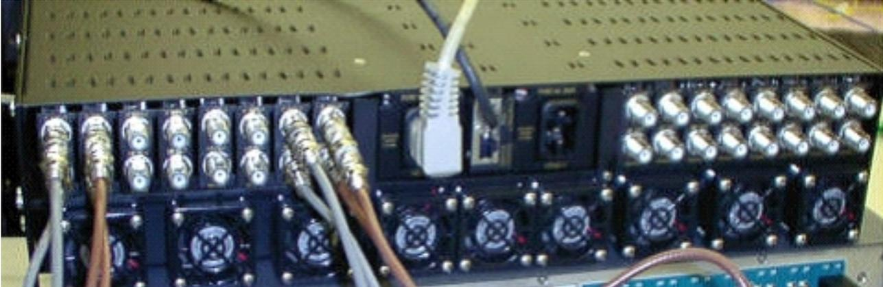
Los módulos se etiquetan como A a P y se relacionan con los módulos 1 a 16, cuando se configuran las configuraciones en el 7200. Los módulos de la figura 1 se muestran de derecha a izquierda porque la figura 1 es la vista trasera.
