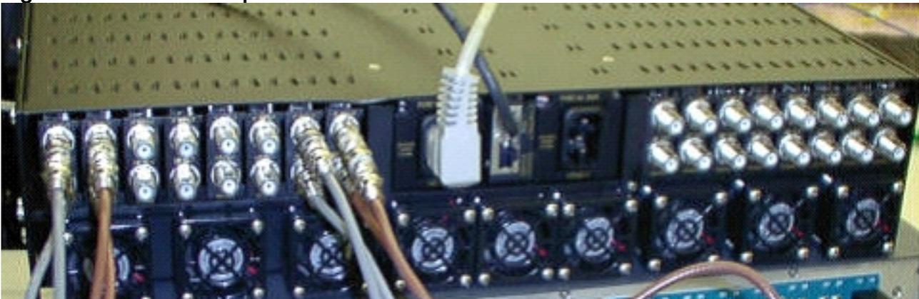
**Nota:** El convertidor ascendente tiene su propia función de redundancia, pero no la activa. Esta función es para la redundancia del convertidor ascendente cuando una señal IF se divide para alimentar dos módulos convertidores ascendentes adyacentes y la salida RF se combina a través de un divisor. SNMP se ocupa de esta función de redundancia de convertidor elevador.
