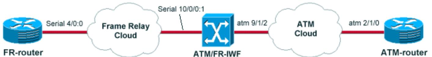
**Nota:** El router ATM es un router 7500 que utiliza un PA-A3-OC3MM en un VIP2-50 y ejecuta 12.1(13)E. El router FR es un router 7200 que ejecuta 12.1(17). El switch ATM/FR-IWF es un Catalyst 8540MSR que ejecuta 12.1(12c)EY.
