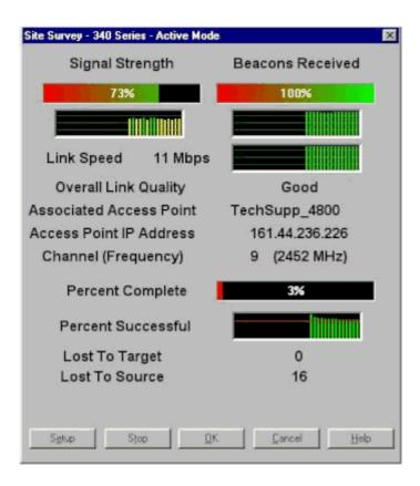
Führen Sie den Carrier-Test durch, um die Aktivität im HF-Spektrum zu sehen. Der Carrier-Test ist für Brücken verfügbar. Mit dem Test können Sie das Funkspektrum anzeigen. Das folgende Beispiel zeigt den Carrier-Test auf dem BR500:
