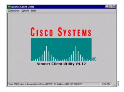
Wenn die Karte einem AP zugeordnet ist, aber nicht mit dem Netzwerk kommuniziert, überprüfen Sie auf der Ethernet-Seite, ob der AP ordnungsgemäß mit dem LAN kommuniziert. Verwenden Sie die Ping-Option im AP, um das Gerät im LAN anzupingen.
