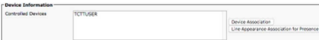
Sie können einem Benutzer ein Gerät zuweisen, indem Sie die Schaltfläche **Device Association (Gerätezuordnung)** auswählen. Daraufhin wird das Menü **Benutzergerätezuordnung** angezeigt. Hier können Sie nach den CUCM-Endbenutzergeräten suchen. Wenn Sie ein Gerät finden, aktivieren Sie das Kontrollkästchen neben dem Gerät, und wählen Sie **Ausgewählte Änderungen speichern aus**.
